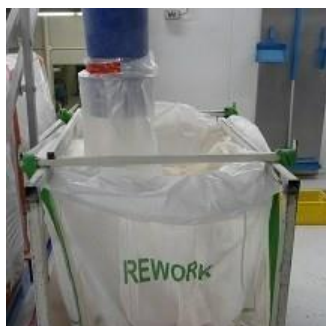
Big Bag onder filterinstallatie
